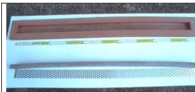
Fig. 3 - Tipico comportamento convesso di una malta che espande all'aria
