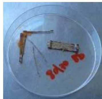
Fibre corrodibili, prova non superata
